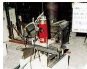
▲引抜き試験の状況
